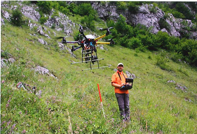
Abb. 3: E.C.O.ptyrx im Einsatz. Der Hexakopter mit GPS-gestützter Flugsteuerung liefert hochauflösende Luftbilder von den Lebensräumen als Grundlage für die Geländekartierung. (Foto: E.C.O., Jungmeier)
